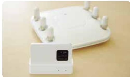
地域BWAの無線端末(Wi-Fiルーター/手前)と通信機器400台が接続できるアンテナ。
