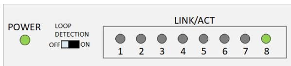
PC等を情報コンセントへ接続している部屋(例では「部屋1」)のLEDが消灯している状態。
