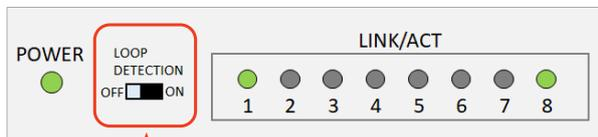
インターネットを使用している「部屋1」と「幹線」側ポートに対応するLED に対するが点灯・点滅している状態。
